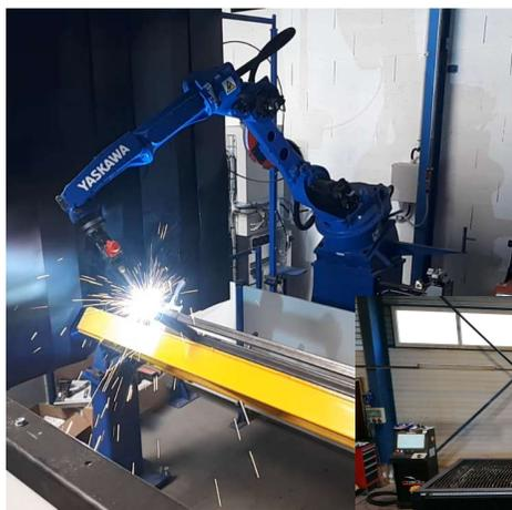
Robot de soudure
